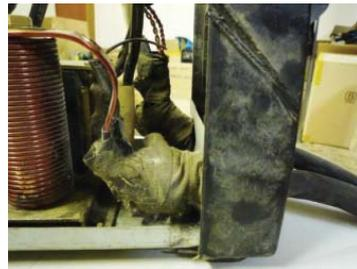
Пыль и грязь внутри аппарата, а особенно на платах управления и радиаторе приводят к преждевременному выходу из строя сварочных инверторов.
